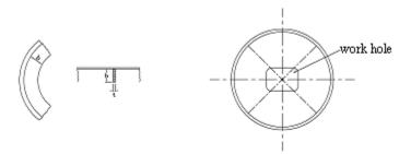
Fig.C10.6.1 Ring stiffener Fig.C10.6.2 Diaphragm
